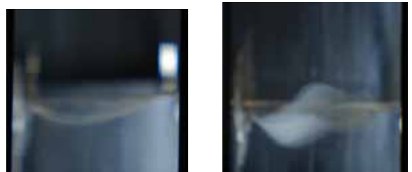
図7 異方倍率レンズによる振動モード撮影
