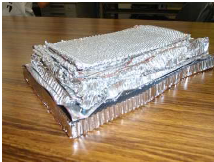
図5 実験後のハニカムコアの様子
